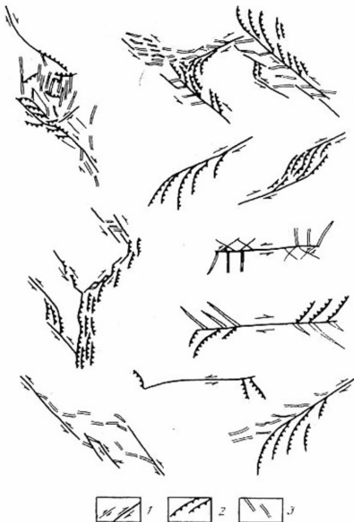
Рис. 8. Некоторые широко распространённые рисунки ансамблей парагенезов структур. 1—3 – парагенезы структур: 1 – сдвига, 2 – сжатия, 3 – растяжения
