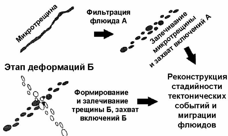
Рис. 4. Схема формирования генераций ПСФВ различной ориентировки, состава и свойств при изменении плана деформаций. Определяется хронология тектонических событий и флюидопроницаемости пород [по Lespinasse, 1999]
