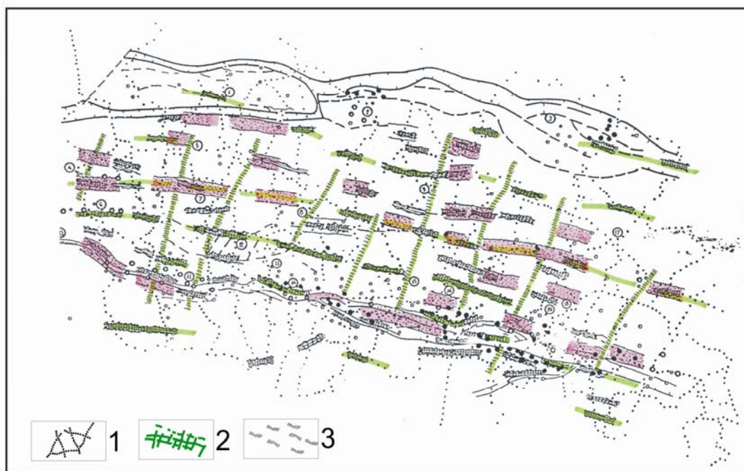
Рис. 6. Схема распределения в плане аномалий современных вертикальных движений, наблюдаемых в зонах разломов в пределах центральной части Северной структурной зоны Припятского прогиба.
