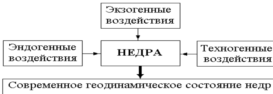
Рис. 8. Схема формирования современного геодинамического состояния недр
